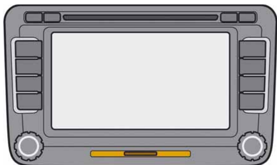
Cadre du RNS 510 avec lecteur de cartes SD, S397_120 par ex. sur la Golf, le Tiguan, le Touran et la Passat
