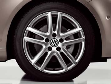
Das Leichtmetallrad „Siena“ von Volkswagen Individual* im Format 7 J x 17 für Bereifung 225/45 R 17 erhalten Sie mit einer Oberflächen-Lackierung in Titan-silber. Auch bei diesem Rad besitzt Ihr neuer Golf Plus ein Sportfahrwerk. Nicht für Trendline.
