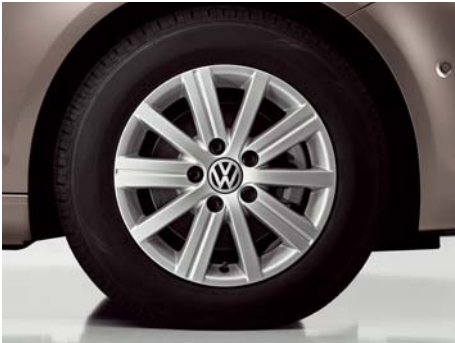
Das Leichtmetallrad „Wellington“ im Format 6 ½ J x 15 mit Bereifung 195/65 R 15 wirkt mit seinen zehn Speichen in zwei verschiedenen schlichten Designs ausgesprochen harmonisch. Nur für Trendline.
